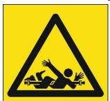
Оборудование приводится в действие при помощи карданного который вала. несёт повышенную одежды опасность захвата и наматывания конечностей. Это может привести серьёзным К травмам.
