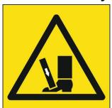
Существует опасность случайного опускания навесного устройства из поднятого положения.
