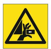
Вероятна опасность раздавливания или удара при изменении взаимного расположения составных частей оборудования относительно друг друга и устройства относительно трактора при подъеме / опускании.
