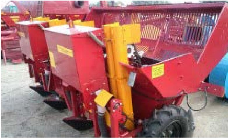
Предназначена для рядковой посадки непророщенных клубней картофеля. Картофелесажалка состоит из следующих основных узлов: рамы, опорно-приводных колес, высаживающих аппаратов, сошников, бороздозакрывателей, загрузочного бункера, редуктора изменения густоты посадки. Оборудована туковысевающими аппаратами для минеральных удобрений.
