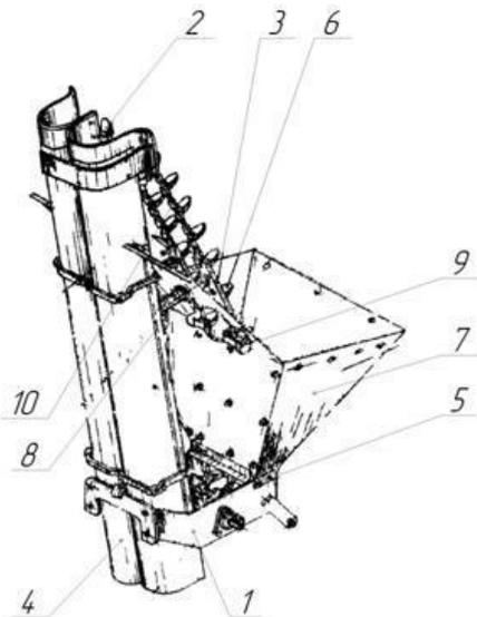
1- основание высаживающего аппарата МНС 02.010; 2 – блок ведомых звездочек МНС 02.190; 3 – встряхиватель МНС 02.050; 4 – кожух в сборе МНС 02.100; 5 – блок ведущих звездочек МНС 02.110 / (МНС 03.010); 6 – ложечка МНС 02.003; 7 – бункер питательный МНС 02.421; 8 – пружина МНС 02.606; 9 – планка МНС 02.901; 10 – цепь ТРД-38-3500-1-2-6-4 ГОСТ 4267-78
