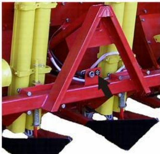
**Рисунок 12 – Место установки вилки штепсельной**
