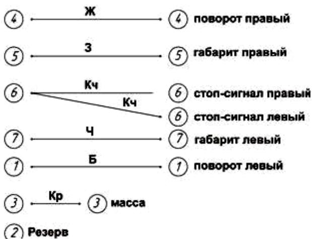
Рисунок 9 – Схема электрическая подсоединения проводов
